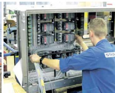
Automatiker im 4. Lehrjahr beim Verdrahten eines 400-V-Steuerschrankes für einen italienischen FLIRT (Schienenfahrzeug für den Regionalverkehr).
