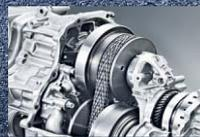
Neu: Lineartronic™, das stufenlose Automatik-Getriebe.
